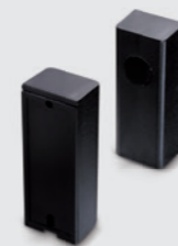
Einweg-Lichtschranke Extra 625 • 24 V DC, IP 54 • Reichweite 8 m • Geeignet für: Alle Antriebsmodelle
