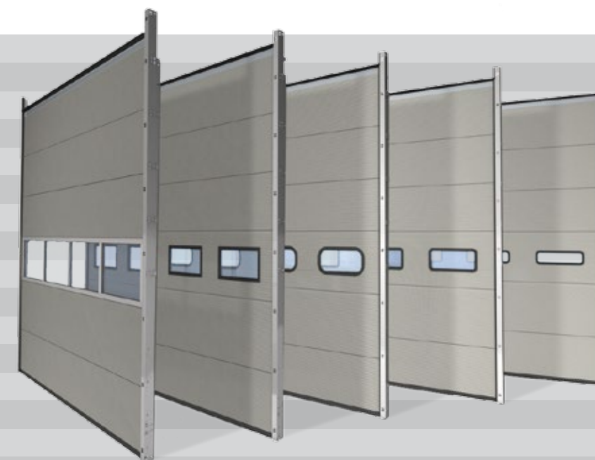
U-Wert ISO 40 mm Sektionaltor: 5000 x 5000 mm: 1,02 W/m²K
